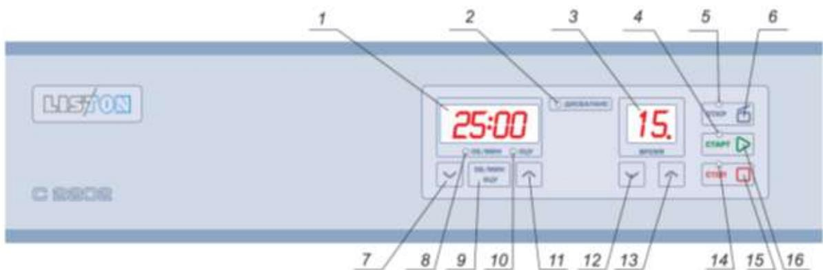
Рисунок 4. Панель управления Центрифугами Liston С 2201, Liston С 2202, Liston С 2203, где:
