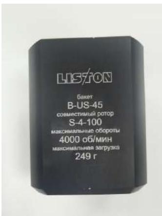
Маркировка бакета, включающая в себя: зарегистрированный торговый знак изготовителя, наименование бакета, совместимость с моделью ротора, максимальную частоту вращения, максимальную загрузку.
