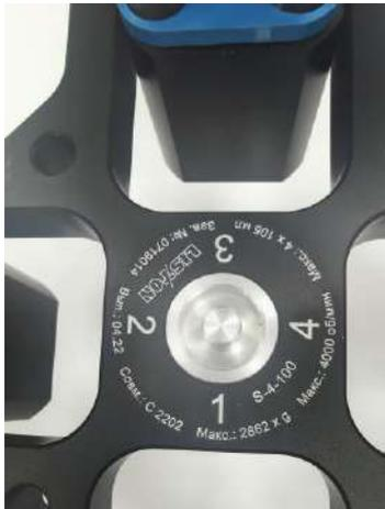
Маркировка ротора, включающая в себя: зарегистрированный торговый знак изготовителя, наименование ротора, заводской номер ротора, цифровую идентификацию посадочных мест, совместимость с моделью центрифуги, максимальную загрузку ротора, максимальное ОЦУ, максимальную частоту вращения.
